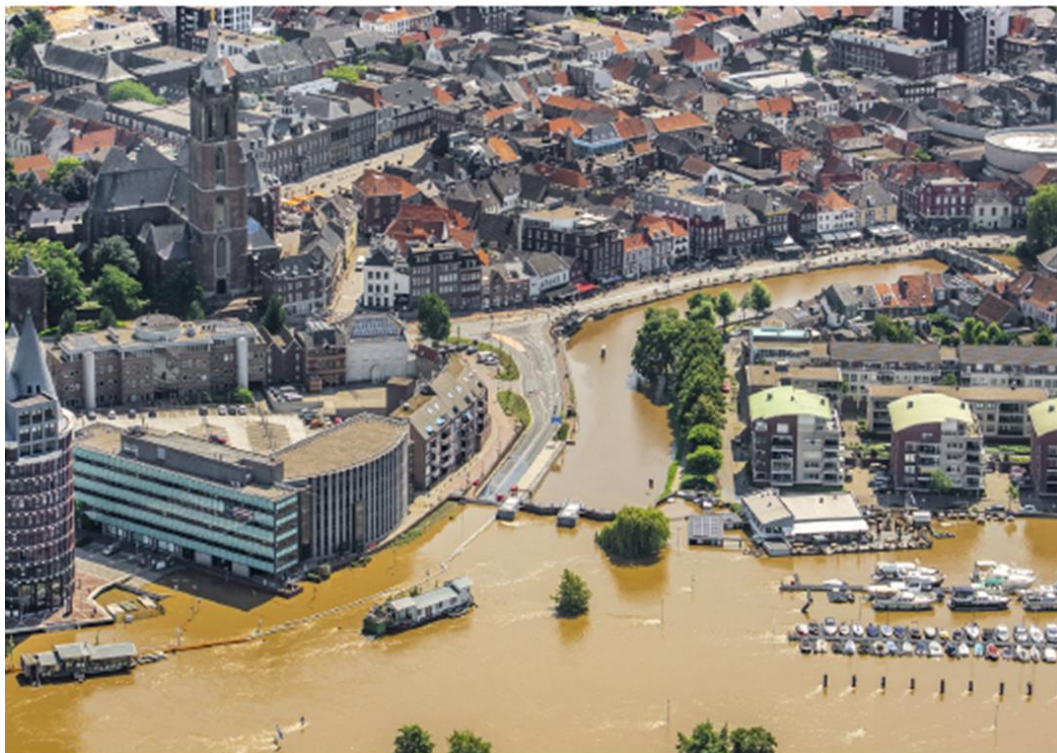
Figuur 5.2 Foto van het centrum van Roermond, tijdens het hoogwater van juli 2021. De foto is genomen vanaf de Maas kijkend naar het centrum van Roermond. De gesloten sluisdeuren, met links daarvan de gesloten coupures op de Looskade, zijn duidelijk zichtbaar. Het water op de Maas stond maximaal ongeveer 1,5 m hoger dan het water op de Roer in de binnenstad van Roermond
