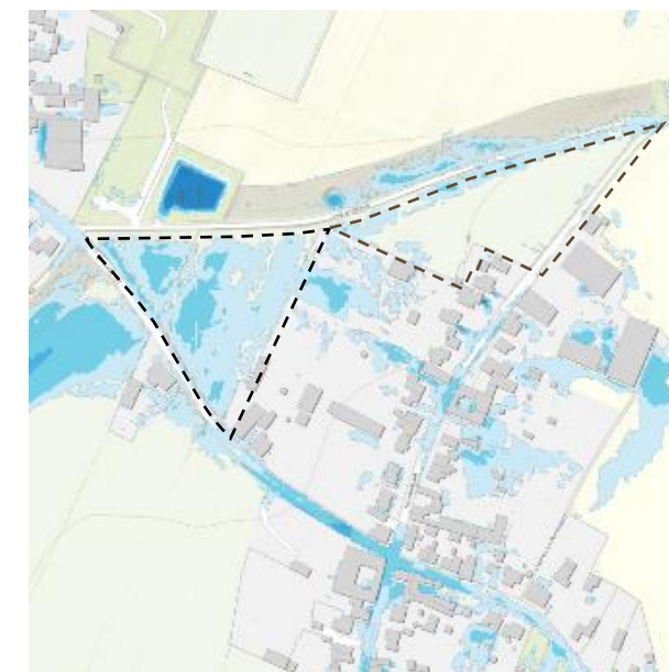
Waterdiepte bij pluviale overstroming 20-50 cm westelijke zijde.
